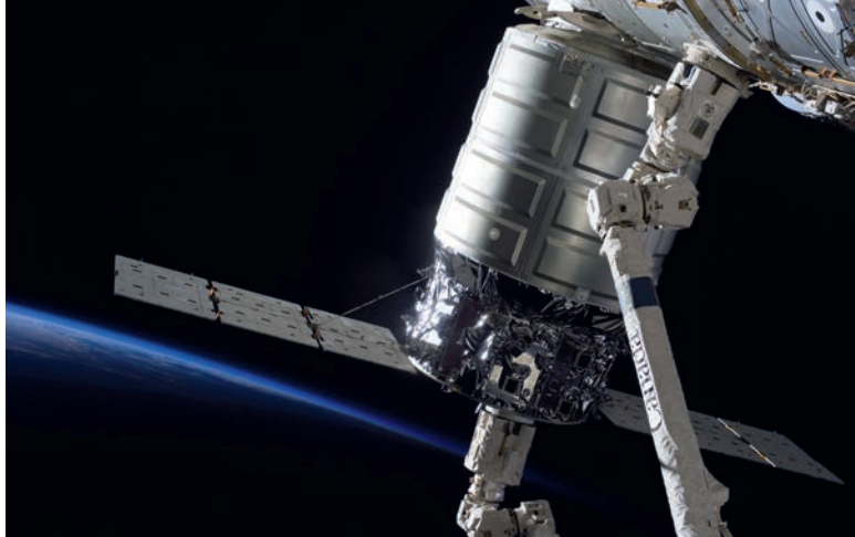
▲ Грузовой корабль Cygnus, захваченный манипулятором Canadarm2, был сфотографирован членами экспедиции МКС-37 сразу после стыковки с американским модулем Harmony.
